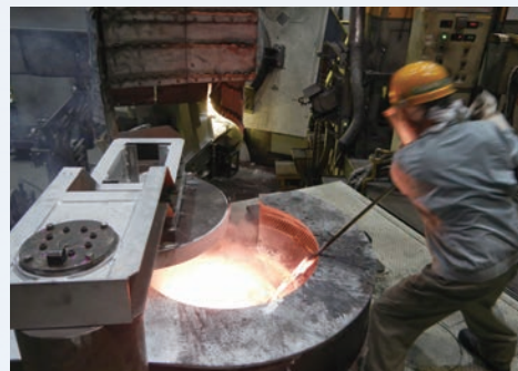
溶湯を棒で攪拌し材料を均一化させ、不純物の除去も行う。
