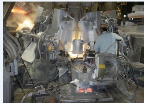
電気炉を傾けて中の溶湯を流し出しているところ。手前中央の赤い部分は溶湯を固める鑄造装置の上部。
