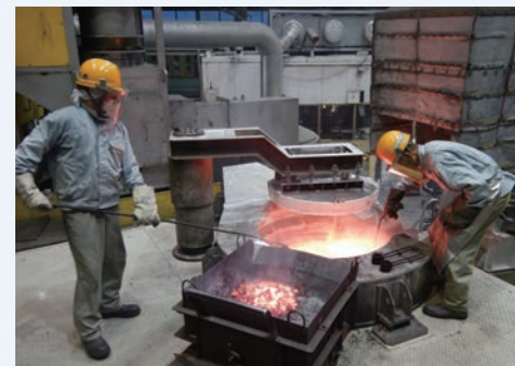
溶湯の表面に浮かび上がった不純物を取り除く作業（左側）を行った後、溶湯内の品質を確認するための試料採取（右側）をする。
