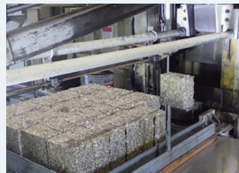
面削屑をプレスしてブロック状の塊にする。
