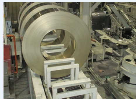
貨幣と同じ厚さまで薄く延ばされた圧延板。
