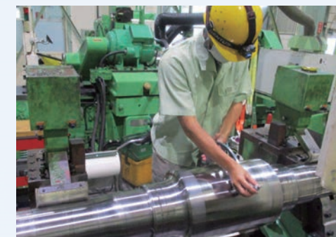
研磨したロールの寸法精度の確認を行っている。
