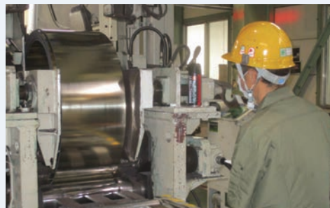
面削直後の圧延板の表面状態を目視確認。
