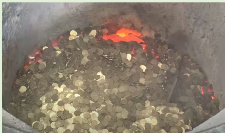
造幣局の溶解炉で回収貨幣を溶解している様子
