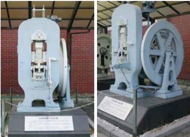
写真14：広島支局仮工場で使用されていた圧印機6台のうちの1台。原爆投下により被爆したが、修理され昭和49（1974）年まで広島支局内の工場で使用された。
