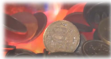
造幣局の溶解炉で回収貨幣を溶解している様子
