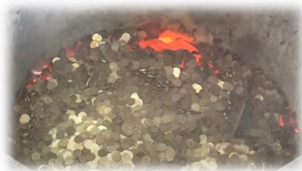
造幣局の溶解炉で回収貨幣を溶解している様子
