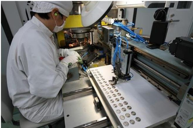
美しさの秘密のもうひとつは、丁寧な圧印作業。専用の圧印機で貨幣の模様を二回以上連続して圧印し、模様を鮮明に付けていきます。高級感のある革ケースに入れたらできあがり！その美しさを是非近くでご覧ください。
