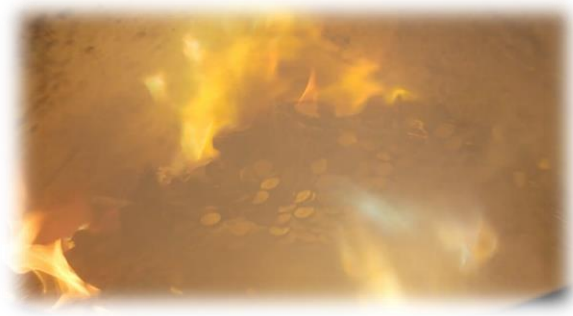
造幣局の溶解炉で回収貨幣を溶解している様子
