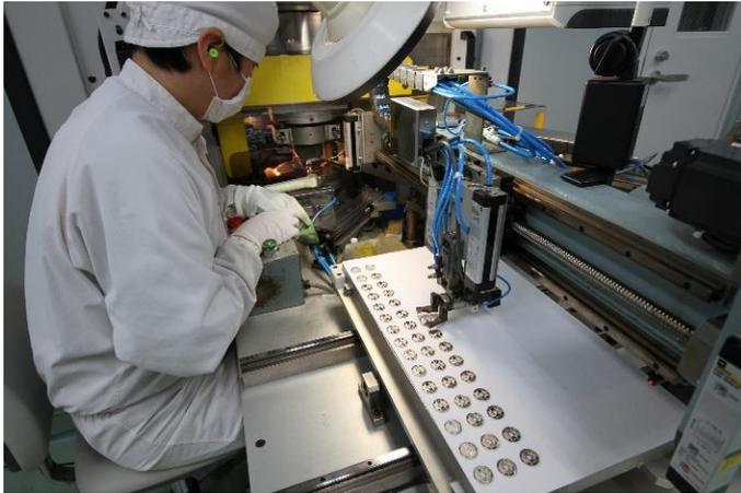
美しさの秘密のもうひとつは、丁寧な圧印作業。専用の圧印機で貨幣の模様を二回以上連続して圧印し、模様を鮮明に付けていきます。
