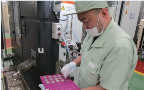
圧印機から測定用の貨幣を採取する。
