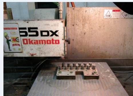
研磨機の上に金型(パンチ)がセットされた状態。
