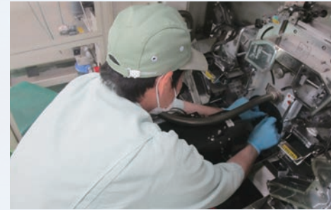
基準となる貨幣の画像を撮影するため貨幣検査機に貨幣をセットする。
