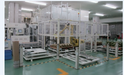
計数から袋詰め及び木製パレット積載までを自動で行う自動封入封緘装置。
