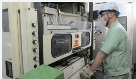
ダイセットが取り付けられたプレス機(圧穿機)の動作確認を行う。
