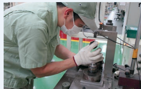
プレス機(圧印機)に極印を取り付けるための部品に、極印の中心がずれないように目視で確認しながら慎重に位置決めをする。
