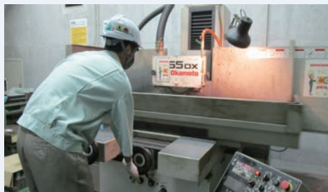
金型(パンチ)を研磨機にセットし、研磨を行う。
