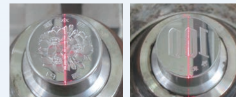
レーザー光を用いて極印を中心に合わせる。真上から線が中心にきているか確認する。(左の写真の職員が見ているもの)
