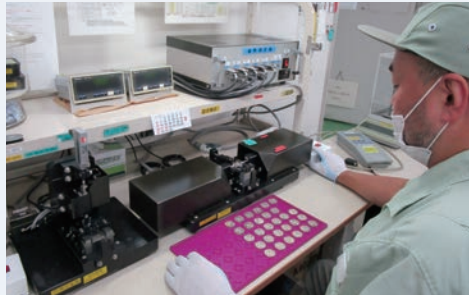
貨幣測定機で貨幣の直径を測定する。
