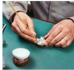
3 七宝が入る部分に「ゆう葉」を盛り付けます。その後、電気炉に入れて「ゆう葉」を焼き付けます。
