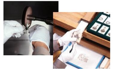
4 羽布<sup>ぼふ</sup>で研磨して光沢を出し、必要な部分には金メッキをします。部品を組み立てて完成です。
