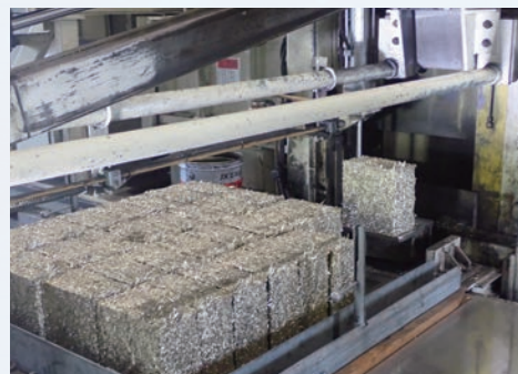
面削屑をプレスしてブロック状の塊にする。
