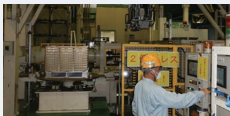
プレス機を使い、後工程で発生した屑地金を圧縮し、扱いやすい塊にする。
