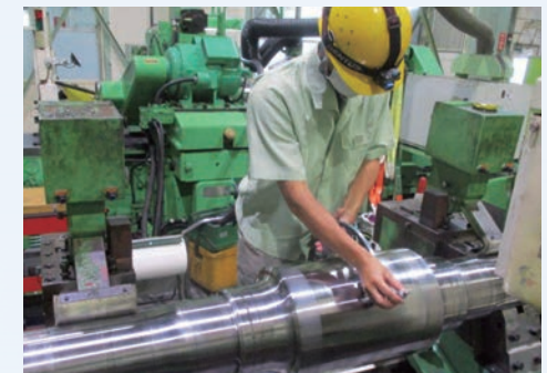
研磨したロールの寸法精度の確認を行っている。
