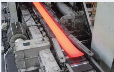
高温の鋳塊が10数回圧延され、板状に引き伸ばされる。
