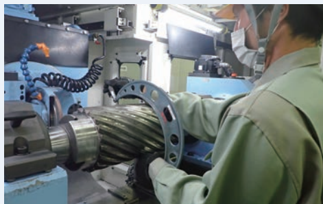
研磨後に面削作業に使うカッターの刃の状態を確認する。
