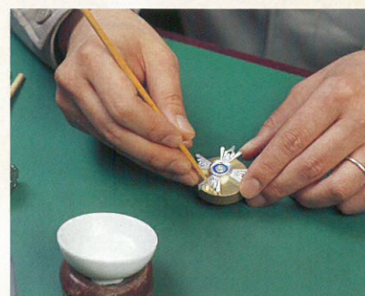
《④七宝盛り付け》 七宝が入る部分に「ゆう薬」を盛り付けます。
