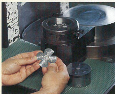
《①圧写（あっしゃ）》 圧写機に極印を取り付け、銀材料板に勲章の模様をプレスします。
