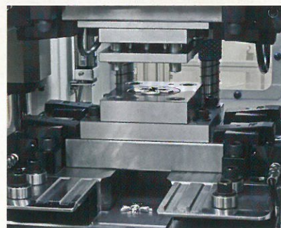
《②切り抜き》 精密成形機などで部品の形に切り抜きます。
