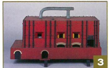
硫酸ソーダの製造設備です。当時は、図面により設備を作ることが発達していなかったため、このような模型を作り、これを基にして建物が建設されました。
