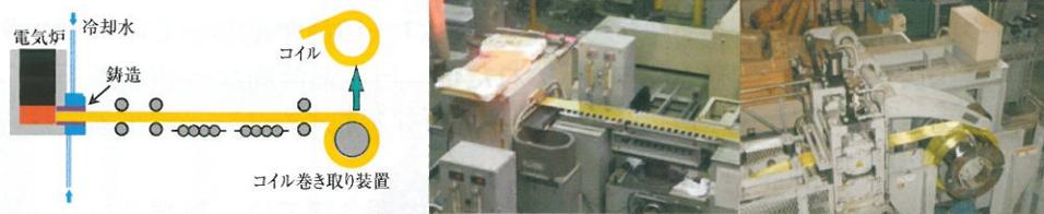
図 1 横型連続鑄造装置
